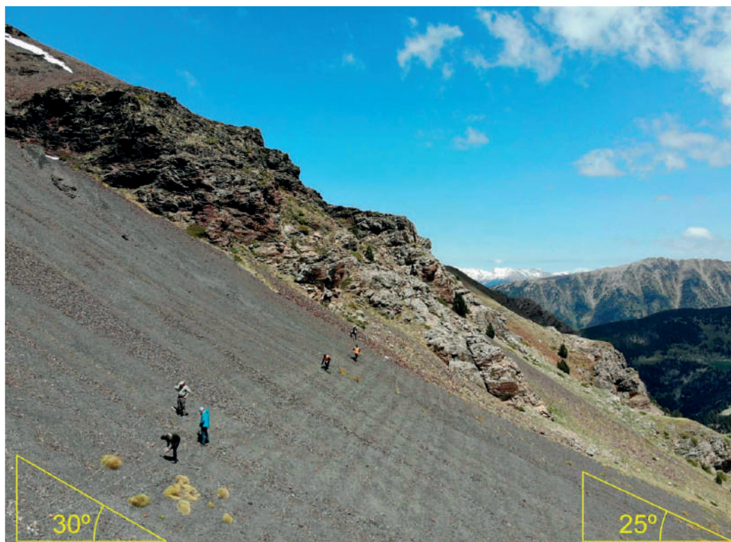
Figura 11: Siembra experimental a bandas en primavera 2022 de los terreros erosionados. Se generó 65 parcelas de 30 m 2 cada una, probando para diferentes densidades de siembra y separaciones (para la banda no sembrada). Como prueba de la eficacia de la ovinorremediación compárese esta fotografía con la de la portada, llena de profundas cárcavas. Se trata de la misma vertiente, una vez regularizada mediante pisoteo de ovejas, ya apta para la siembra.
