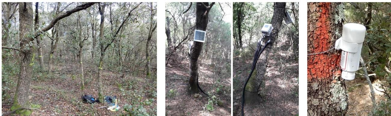
**Figura 10.** Red de seguimiento instalada: Izquierda, parcelas permanentes señalizadas. Centro, dataloggers y sensores de humedad del suelo. Derecha, sensores de temperatura del aire y de humedad relativa.
