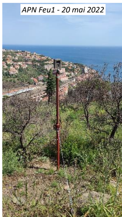
Figure 38 : APN installés en face de chacune des parcelles. Sur les parcelles Feu1 et Feu2, l'installation d'un support haubané a été nécessaire. Sur la parcelle Témoin, la présence d'un pin juste en face de la parcelle a permis de l'utiliser comme support.
