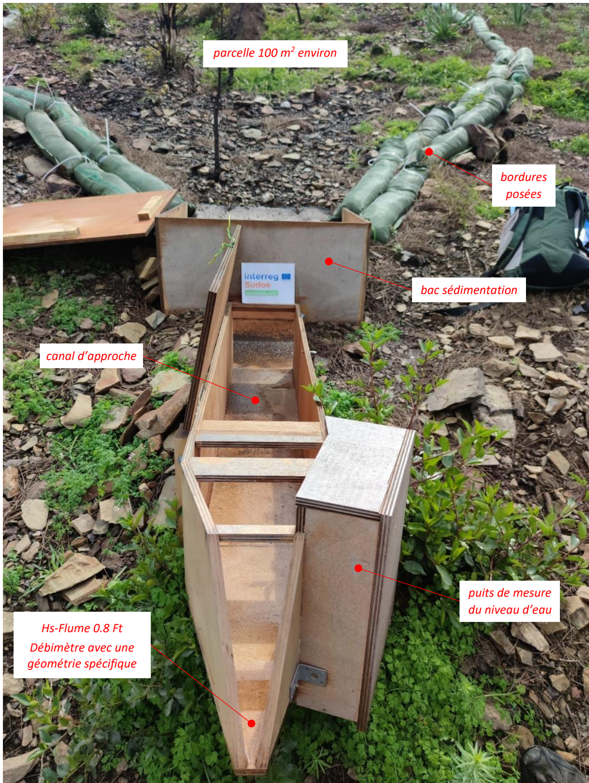
Figure 32 : illustration des équipements qui constituent une parcelle d'érosion
