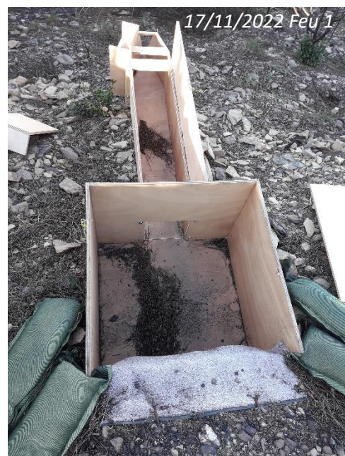
Figure 26 : vue du bac décanteur et du canal d'approche, avec au fond le Hs-Flume. Au premier plan on aperçoit les bordures de la parcelle et le paillason qui fait la transition entre le sol naturel et le dispositif de mesure.
