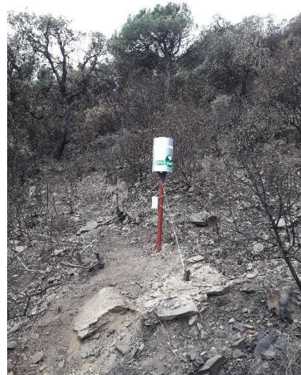
Figure 36 : pluviomètre installé le 21 oct. 2021
