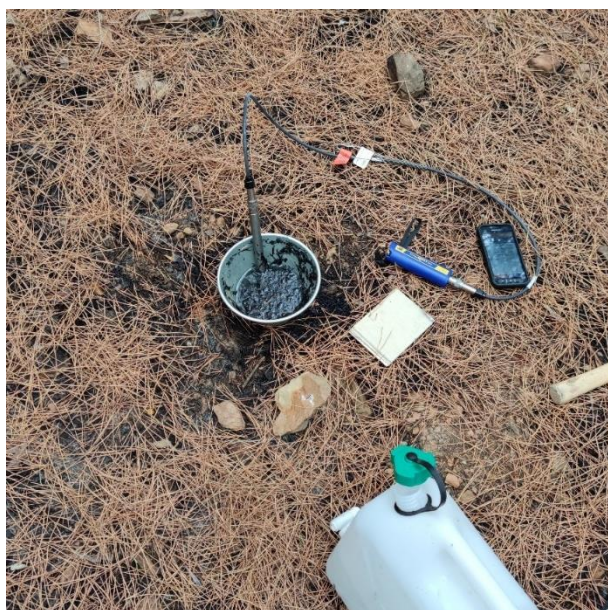
Figure 49 : mise en œuvre des mesures de percolation. Le cône métallique est fiché dans le sol, puis rempli d'eau. Une sonde automatique mesure l'abaissement du niveau d'eau dans le cône.
