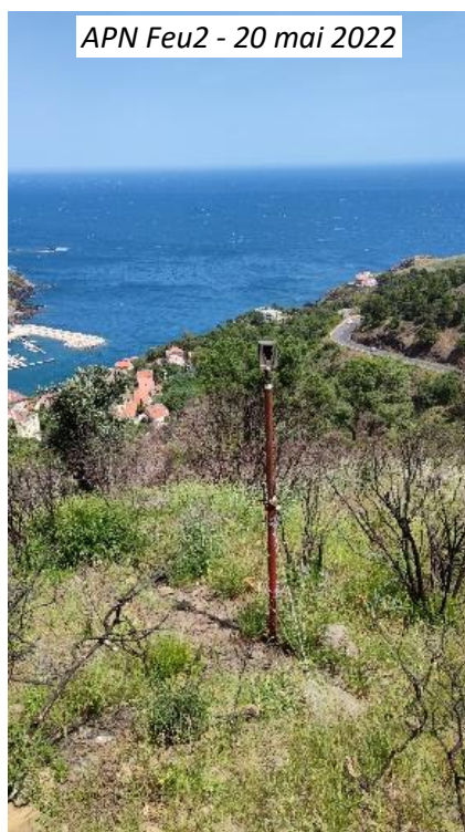
Figure 38 : APN installés en face de chacune des parcelles. Sur les parcelles Feu1 et Feu2, l'installation d'un support haubané a été nécessaire. Sur la parcelle Témoin, la présence d'un pin juste en face de la parcelle a permis de l'utiliser comme support.
