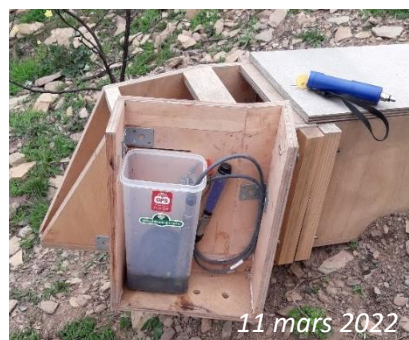
Figure 24 : sonde LevelTroll 500 et son puits de mesure départé
