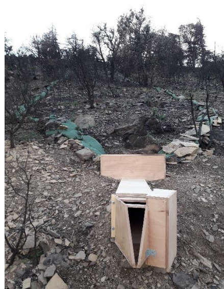
Figure 22: Hs-Flume et son canal d'approche fabriqués en régie; l'utilisation de contre-plaqué permet de réduire les coûts et facilite la réalisation.
